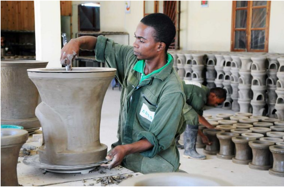
Benjamin Rakotovaomanana am Fertigstellen einer Ton-Brennkammer eines Energiesparkochers für Schulen.
