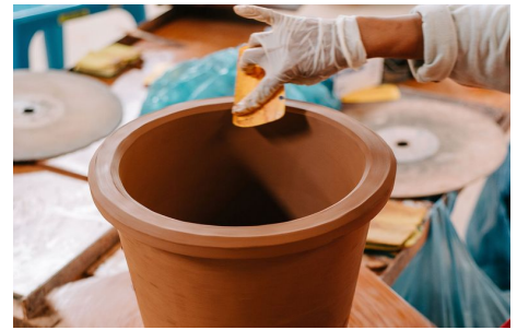
Aus lokalem Ton und Reisschalen werden die Filter gemischt und in Form gepresst. Foto: TerraClear
