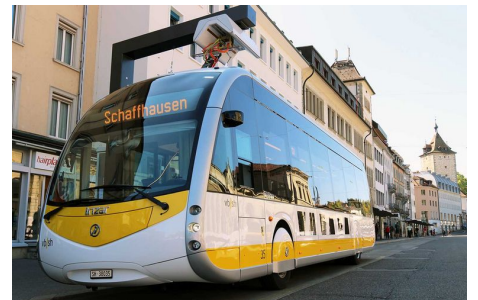
Der E-Bus mit Schnellladesystem der VBSH bezieht die Energie von einer auf dem Dach installierten Batterie, welche sowohl im Depot als auch an einzelnen Haltestellen in kürzester Zeit geladen wird. Foto: Christoph Wahrenberger
