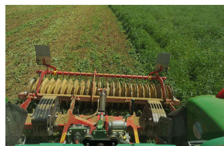
Zwischenkulturen werden schonend mit der Scheibenege als Gründüngung in den Boden eingearbeitet (Foto und Copyright: Peter Fröhlich)
