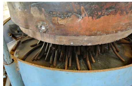
Pellets werden unter hohem Druck hergestellt.
