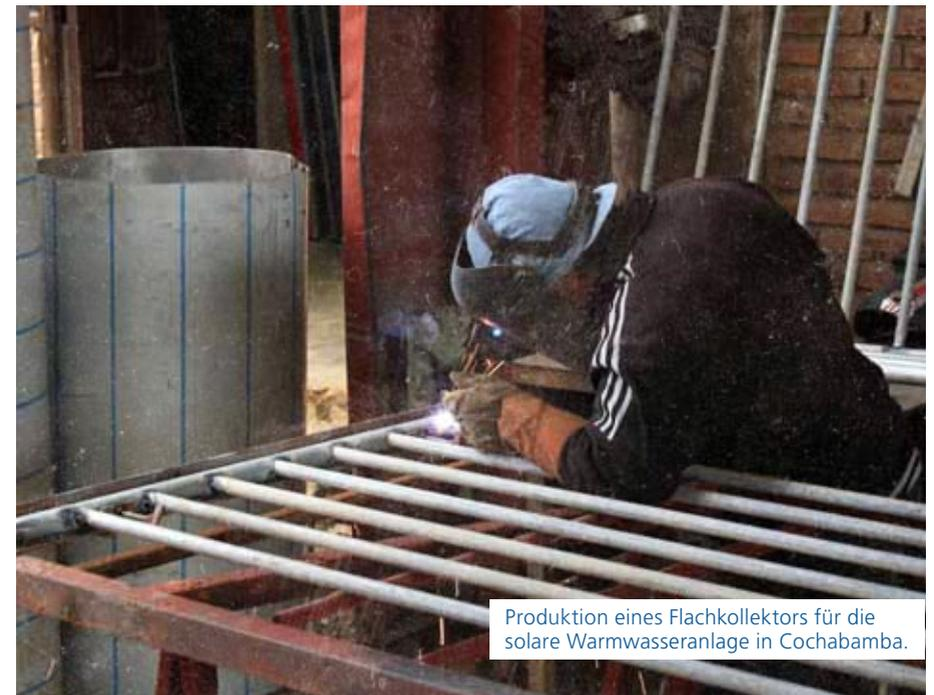
Produktion eines Flachkollektors für die solare Warmwasseranlage in Cochabamba.
