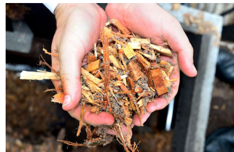
Résidus de biomasse issus d'activités forestières mélangés à des boues issues du processus de production de l'usine
