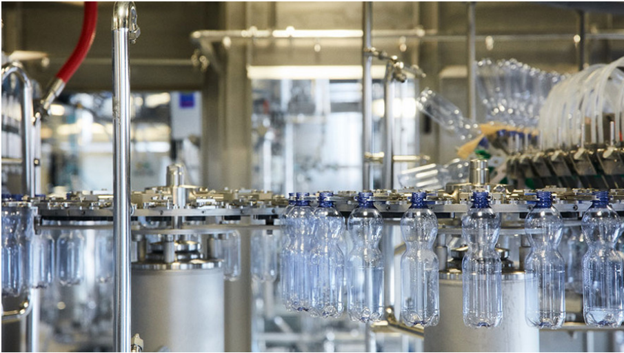
Remplissage de bouteilles en PET chez Aproz Sources Minérales SA. Photo: Charles-Elie Lathion
