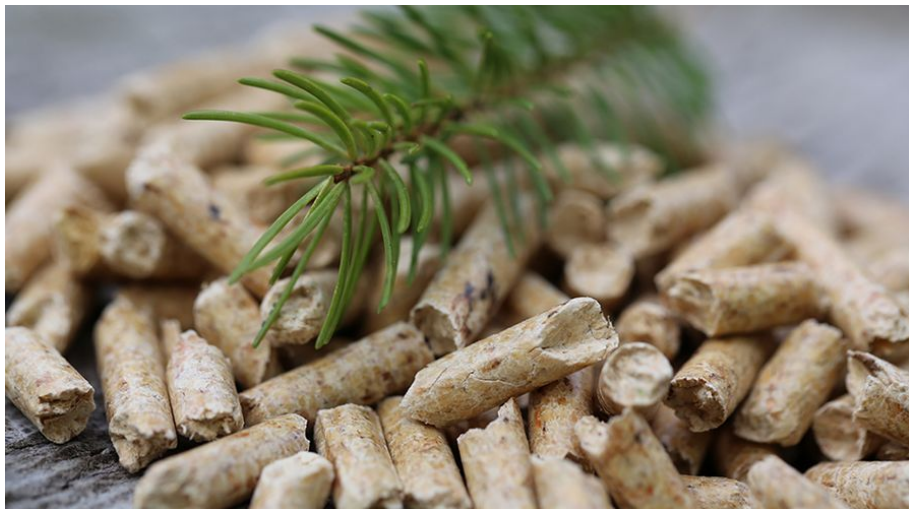
Les granulés de bois cylindriques font 0,6 centimètre de diamètre et jusqu'à quatre centimètres de long. Photo: www.proPellets.ch
