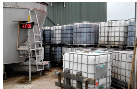
Per la produzione di biogas, i co-substrati come la glicerina, un sottoprodotto della produzione di biodiesel, e gli scarti di grano e verdura sono anche più ricchi di energia del letame.
